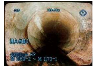
調査の結果、改築の必要がある下水道管
