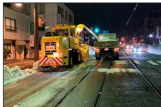
軌道並走区間における連携除雪
