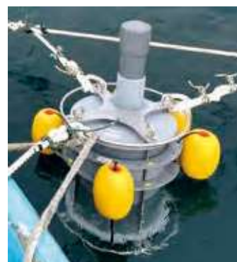
スマート水産業（高解像度魚群探知機搭載ブイ）
