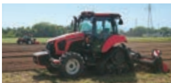
自動運転トラクタと有人運転トラクタとの2台協調作業
