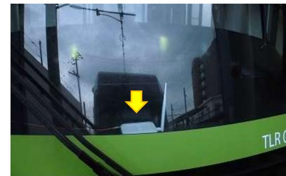
路面電車に設置されたLoRa GPS発信器
