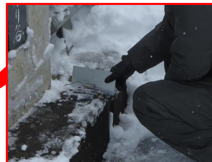
鉄板挿入による動作確認状況
