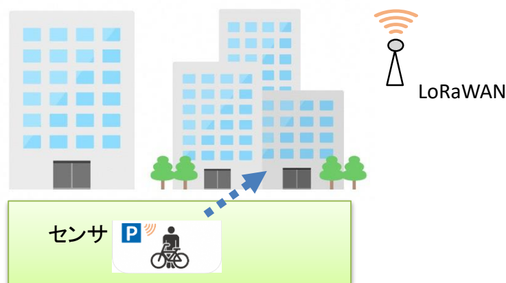
中継器が無い場合、LoRAWAN基地局との通信が困難
