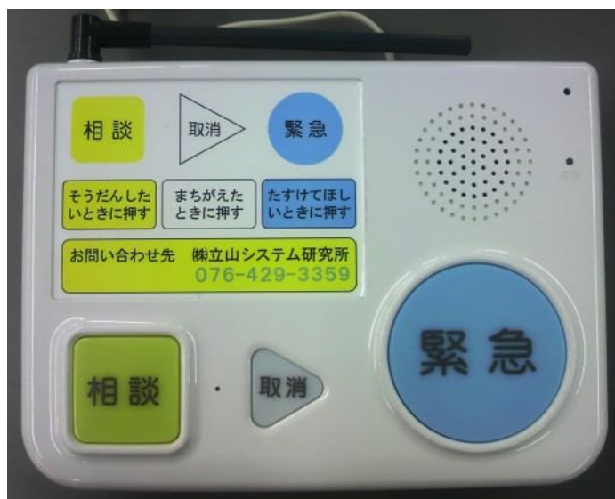
緊急通報装置（本体）
