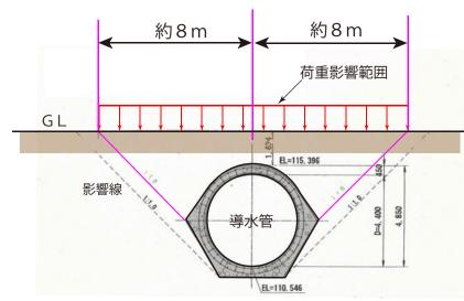
※荷重影響範囲の幅は、導水管上部の土被り厚に比例して多少拡縮する。 当該敷地内での最大幅は約16m(導水管中心線より片側約8m)となる。
