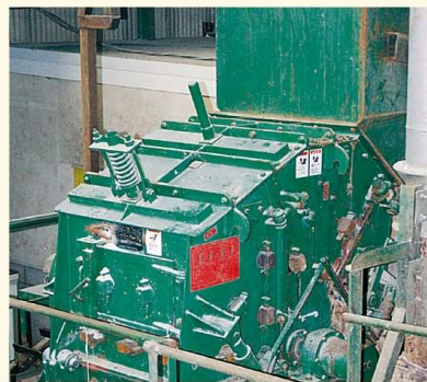
空きびんを粉々に砕く機械に入れ、 びん工場で使いやすい大きさにします。
