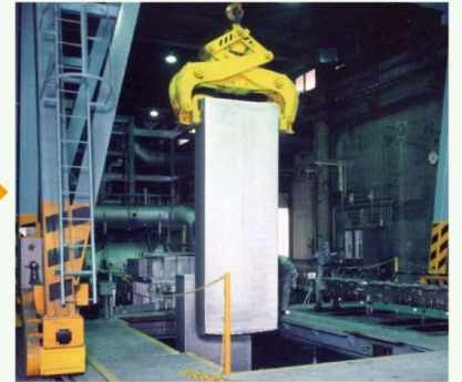
溶けたアルミを流しこみ、アルミの塊を作ります。
