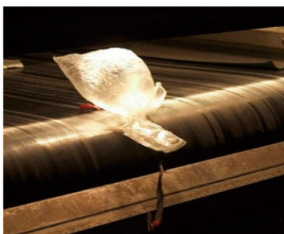
リサイクルする工場 せいひん で、光を使い、選別します。
