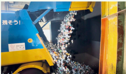
回収車から空き缶を押し出しています。
