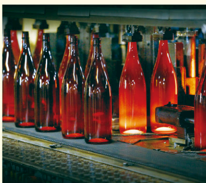
原料を高温で溶かしてやわらかいガラスにし、機械でびんの形にします。
