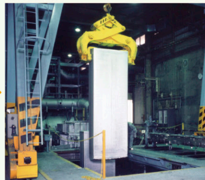
溶けたアルミを流しこみ、アルミの塊を作ります。
