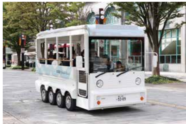
※1 グリーンスローモビリティ 時速20km未満で公道を走ることができる電動車を活用した小さな移動サービスで、その車両も含めた総称 富山駅北地区
