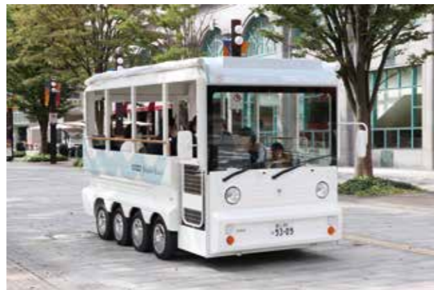
※1 グリーンスローモビリティ 時速20km未満で公道を走ることができる電動車を活用した小さな移動サービスで、その車両も含めた総称
