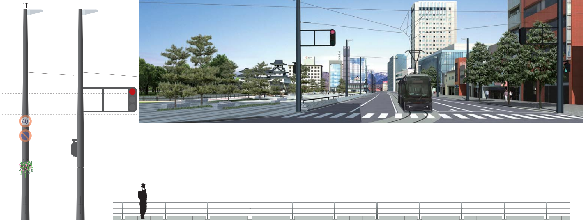
架線柱+車道照明
