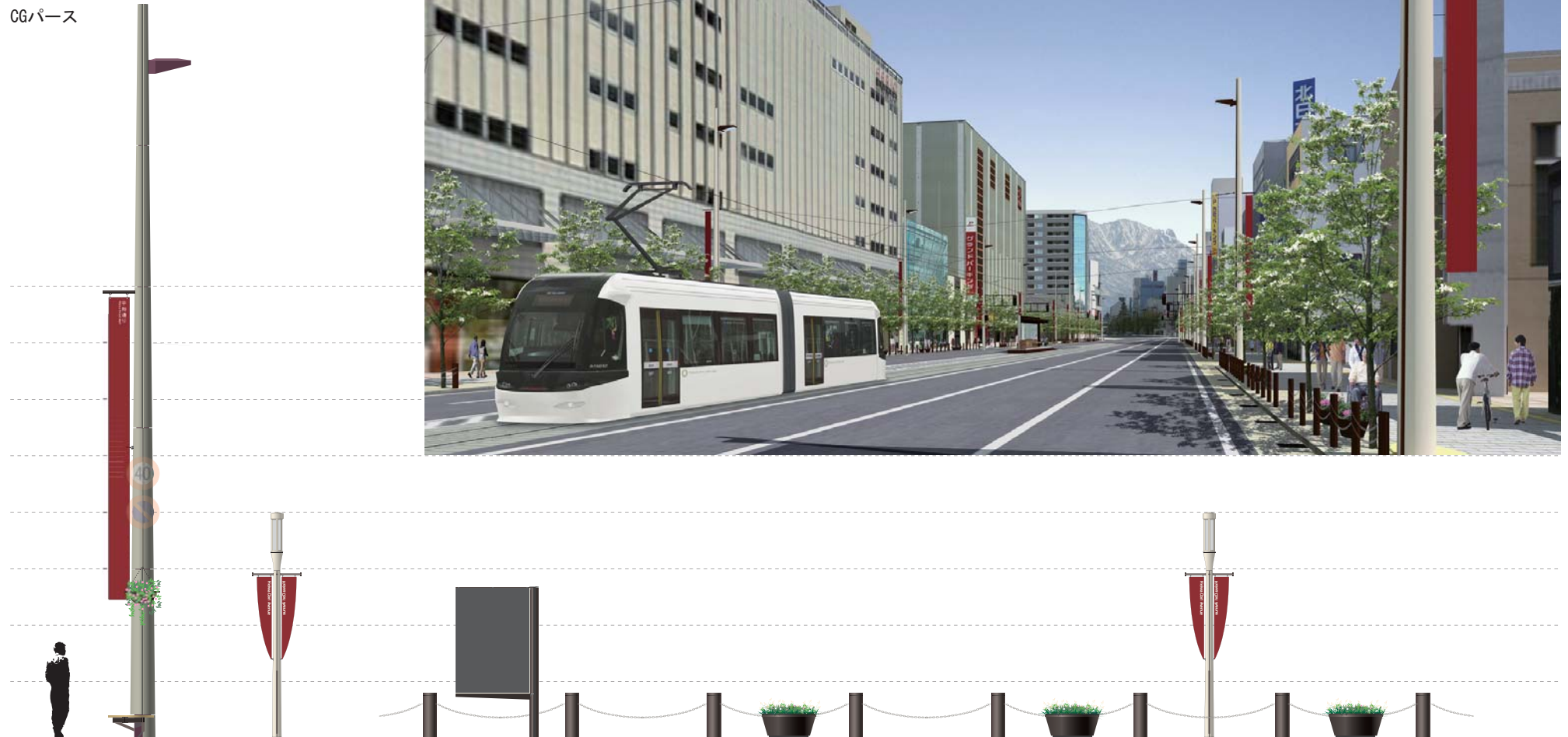
架線柱+車道照明+ベンチ
