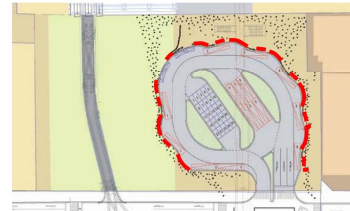
図-17 防風パネル設置箇所
