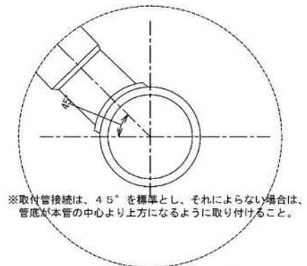
図 3-7 取付管接続拡大図
