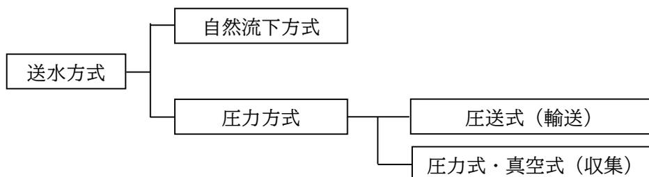
図 3-2 管路施設の送水方式
