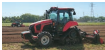
自動運転トラクタと有人運転トラクタとの2台協調作業
