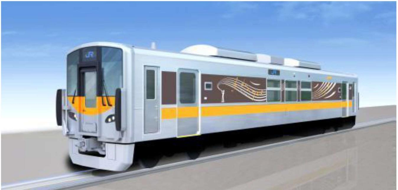
＜参考＞新型電気式気動車（DE700）の車両イメージ
