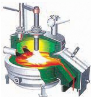
灰溶融炉の内部
