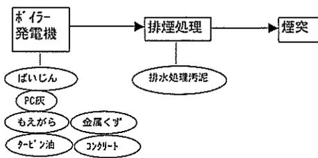
図4 温水、蒸気ボイラー
