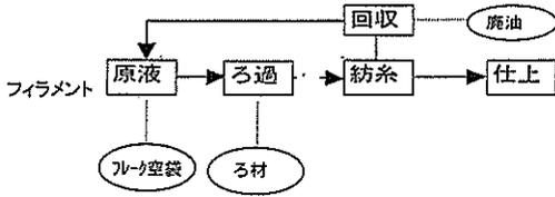
図2 樹脂製造部(アクリル樹脂製造工程)
